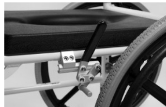
Abb. 4: Befestigung der Bremsen am Rahmen
